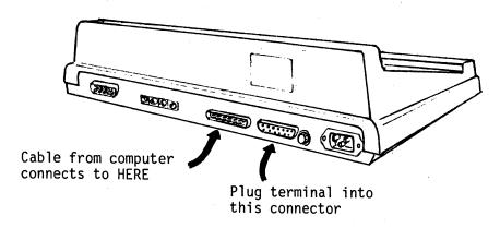
CONNECTING THE TEKTRONIX 4662 PLOTTER
